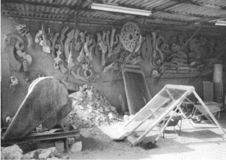
Blick in eine Terrazzo-Werkstätte. An der Wand hängend eine große Zahl von Holzschablonen zum Streuen von Mustern
